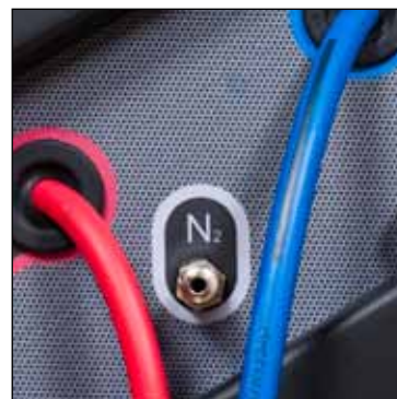
Nitro Fonction détection de fuite à l'azote et au mélange Azote + H 2 avec embouts pour connexion bouteille externe
