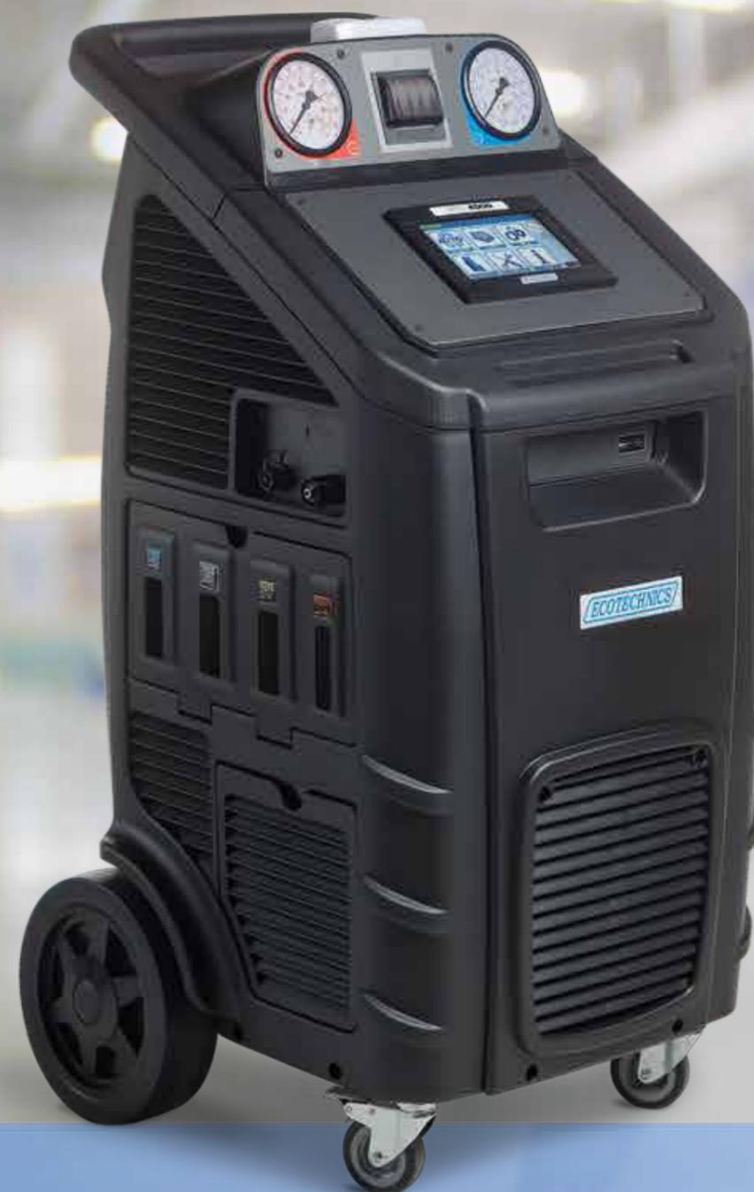
Ambas as unidades incluem um ecrã tátil a cores de 7" que garante uma navegação fácil, intuitiva e extremamente fácil de utilizar, função híbrida patenteada para compressores acionados eletricamente e teste de pressão com gás ou nitrogénio. Existem também 2 frascos herméticos e recarregáveis para óleos novos e 1 para o líquido contrastante.
