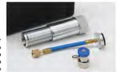
En caso de avería del compresor u otro componente, es obligatorio retirar las virutas metálicas que pudieran haberse acumulado en el interior del sistema antes de una nueva instalación. Los fabricantes de muchos compresores no otorgan una garantía que cubra sus nuevos componentes a menos que el sistema de A/C se vacíe mecánicamente antes de la instalación.
