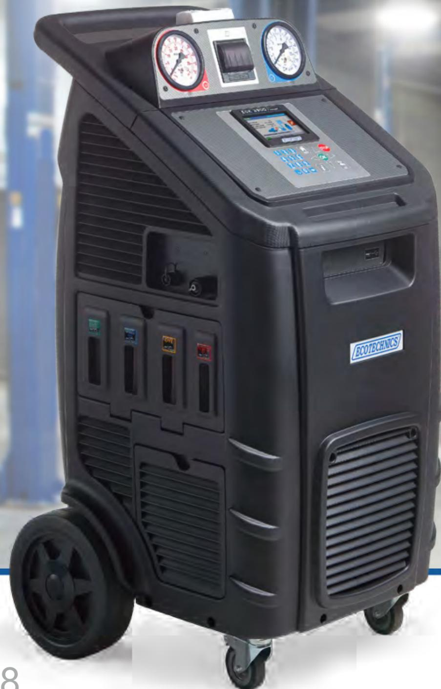
Estación de carga de refrigerantes para A/C, totalmente automática para la recuperación, reciclaje y recarga con refrigerantes HFO1234yf o R134a. La alta tasa de recuperación de refrigerante garantiza una importante contribución a la protección del medio ambiente. El colector de aluminio patentado y muy compacto hace que la estación de servicio A/C sea única y rápida, reduciendo la tubería interna y, por lo tanto, aumentando la eficiencia y la confiabilidad.
