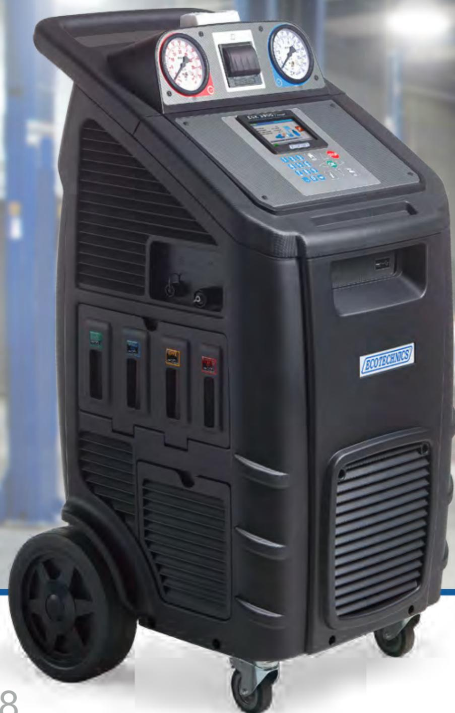
Máquina de A/C totalmente automática para recuperação, reciclagem e carga com refrigerantes HFO1234yf ou R134a. A elevada taxa de recuperação de refrigerante garante uma contribuição crucial para a proteção ambiental. O coletor de alumínio patenteado e muito compacto torna a máquina de A/C única e rápida, reduzindo as tubagens internas, aumentando assim, a eficiência e a fiabilidade.
