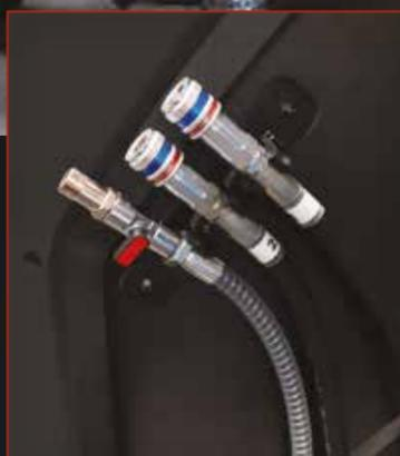
2 RACCORDI E TUBO SCARICO OLIO USATO
