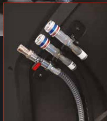
2 CONECTORES Y MANGUERA DE DRENAJE DE ACEITE USADO
