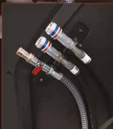
2 CONECTORES Y MANGUERA DE DRENAJE DE ACEITE USADO
