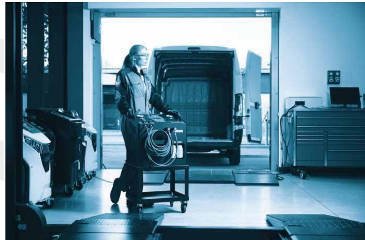
Produit spécial d'Ecotechnics pour le réfrigérant R134a ou HFO1234yf. Station de recharge ECK LAND est conçue pour être facilement déplacée: taille compacte, faible poids, poignées et crochets pratiques pour la fixation pendant le transport.
