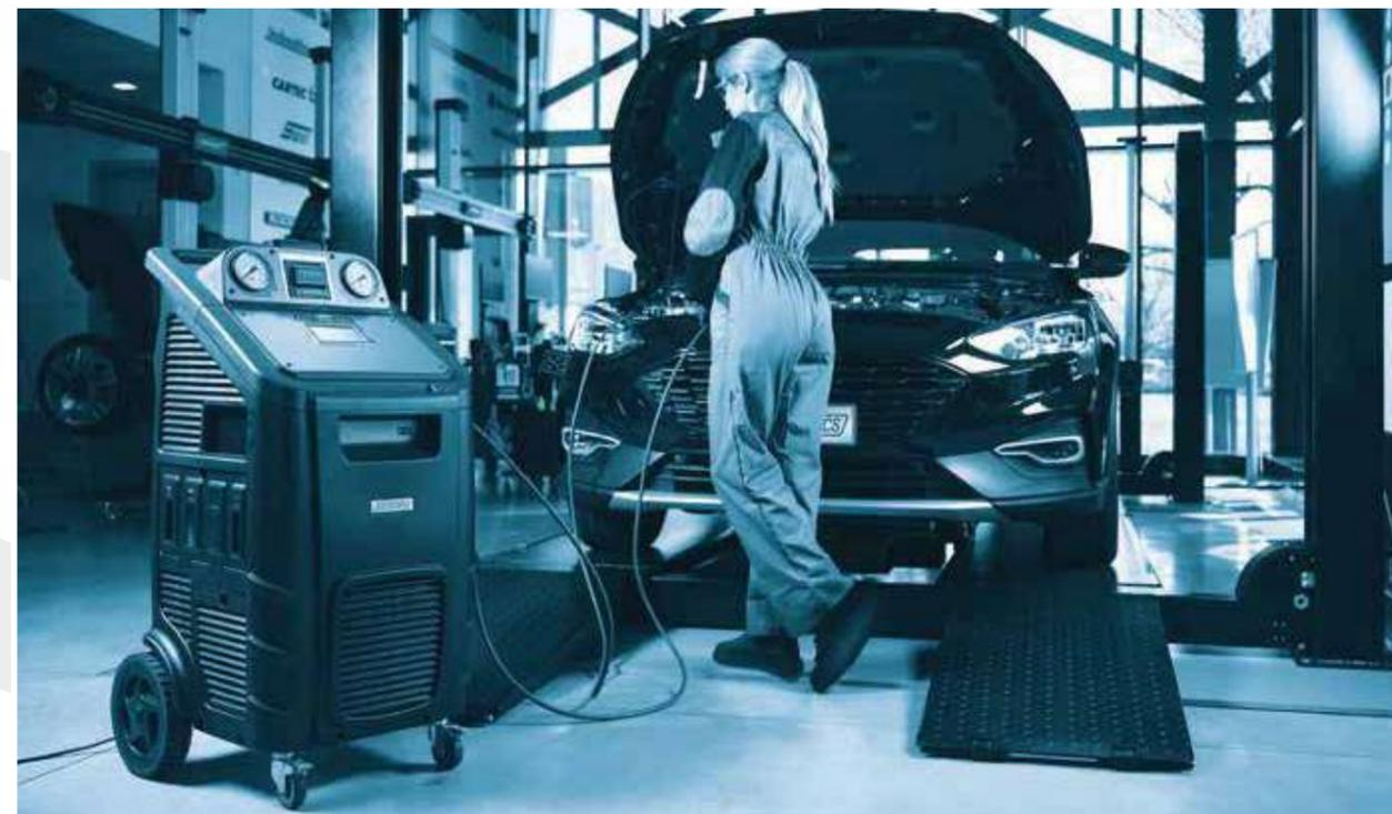
La station ECK 1900 PRO est conçue pour différents types de réfrigérants. ECK 1900 PRO enrichit l'équipement avec un conteneur supplémentaire d'huile/traceur et un réchauffeur de bouteille. La fonction Hybrid est de série. Des caractéristiques supplémentaires en option font de cette station une solution rapide et flexible.
