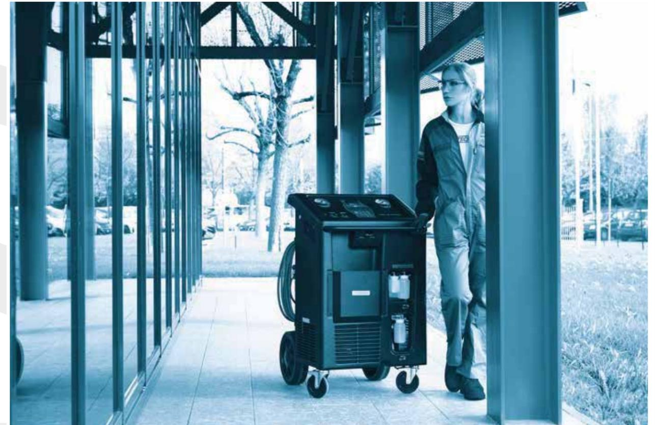
Produit spécial d'Ecotechnics pour le réfrigérant R134a. Les caractéristiques techniques de l'ECK BUS PRO permettent de gérer les grands systèmes climatisation tels que ceux des bus ou des trains.
