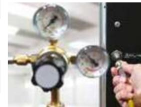
Contrôle de la pression d'azote
