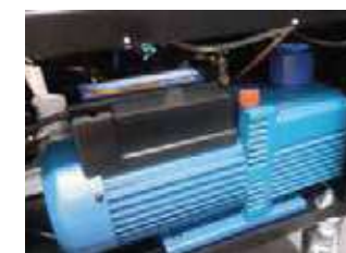
Potente pompa per vuoto 142 l/min a doppio stadio
