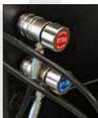
Acoplamentos rápidos SAE J639 Função híbrida
