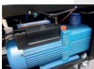
Bomba de vácuo de duplo estágio de 142 l/min torna a máquina adequada mesmo para sistemas de grandes dimensões (comboios, autocarros)
