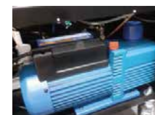
Starke Vakuumpumpe 142 l/min zweistufig
