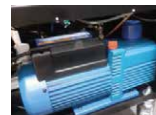
Potente bomba de vácuo de duplo estágio 142 l/min
