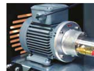
Bomba de engrenagens
