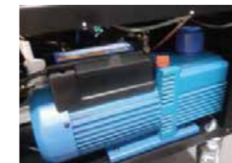
Starke Vakuumpumpe 142 l/min zweistufig
