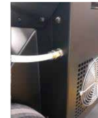
Schnellsteck- verbindung für CO 2 -Ablassschlauch
