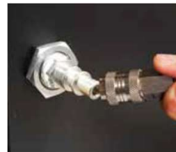
STICKSTOFF Automatischer Lecktest mit Stickstoff / Formiergas
