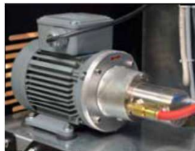
ZAHNRADPUMPE Zur schnelleren Kältemittelbefüllung (1000 gr / min)
