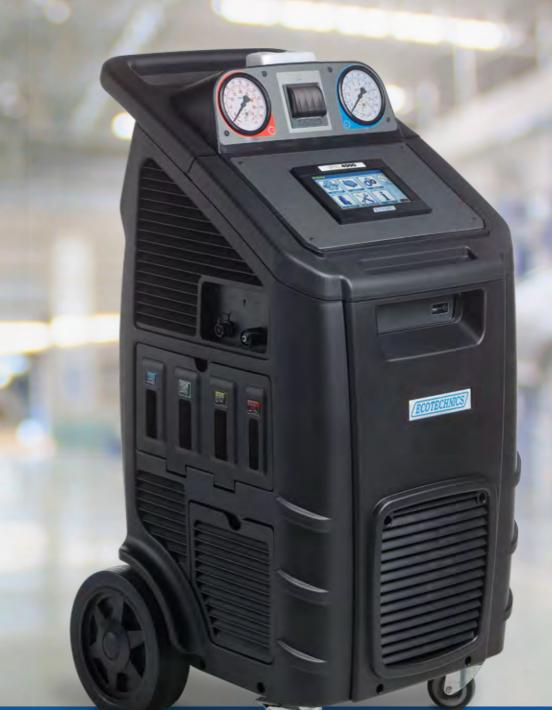
Bei beiden Maschinen garantiert als Standard ein 7"-Farb-Touchscreen einfache, intuitive und benutzerfreundliche Menüführung. Auch die patentierte Hybridfunktion für elektrisch angetriebene Kompressoren und der automatische Drucktest mit Formiergas oder Stickstoff sind Standard. Es sind drei hermetische und wiederbefüllbare Behälter verbaut.
