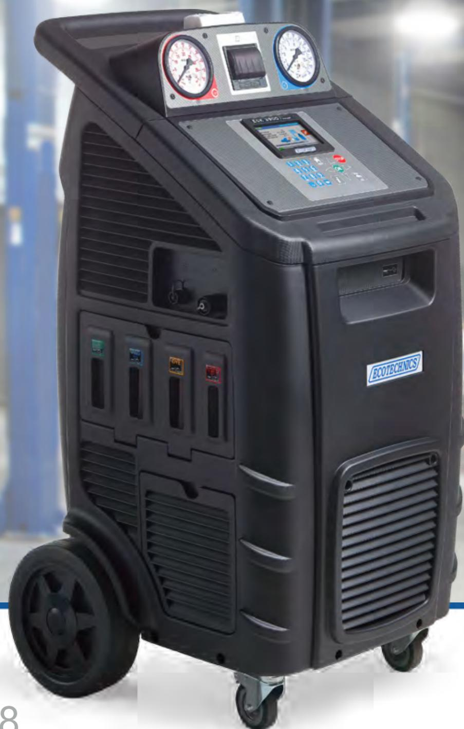
Apparecchiatura completamente automatica per il recupero, riciclo e ricarica del refrigerante HFO1234yf oppure R134a. Il tasso di recupero del refrigerante è particolarmente elevato e rappresenta oggi un indispensabile contributo alla tutela ambientale. Il distributore brevettato, compatto e realizzato in alluminio, riduce il numero di tubazioni e connessioni incrementando affidabilità, efficienza e velocità.
