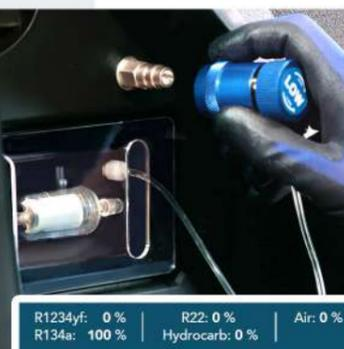
Asegurar la pureza del refrigerante es fundamental para el manejo adecuado de las **Warranties**, para evitar los costos de descontaminación de la estación de A/C y de reparación del sistema de aire acondicionado y para asegurar la eliminación del gas contaminado. En la mayoría de las estaciones de Ecotechnics se puede instalar un analizador o identificador de gas.
