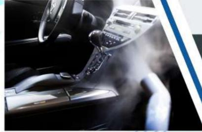
contemporanea con il servizio A/C (brevetto n. EP2349755) oppure in modalità completamente autonoma. Saniflux utilizza la tecnologia ad ultrasuoni per nebulizzare liquidi ed è appositamente progettato per dirigere in maniera precisa il flusso verso la griglia di aspirazione dell'aria all'interno dell'abitacolo. Il veicolo trattato può essere riconsegnato all'utente in tempi rapidi e con un attestato Ecotechnics di avvenuto servizio personalizzato scaricabile online.
