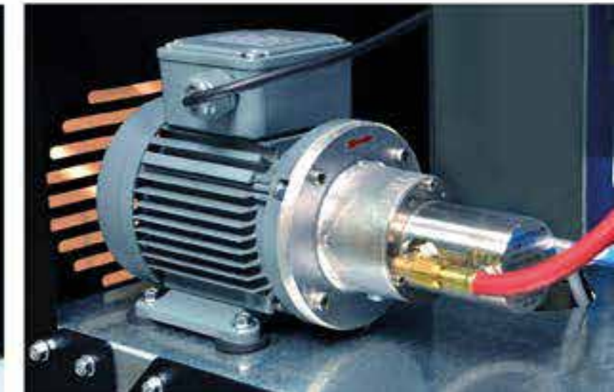
Bomba de engrenagens
